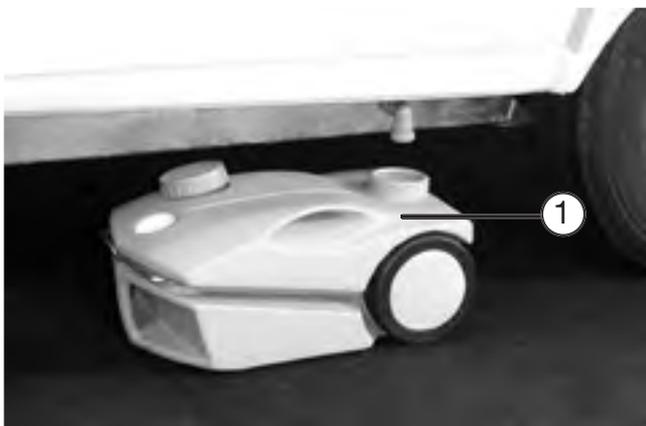
Spillvannstanken som kan rulles (1), kan skyves under kjøretøyet ved stående campingvogn. Den samler opp spillvannet. Volumet er på 22 liter. Spillvannstanken kan transporteres på hjul og med et utfoldbart transporthåndtak for å kunne tømme den på tømmestasjonen.
