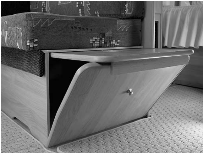
Sistema para extender la cama para vehículos con un conjunto de asientos posteriores
