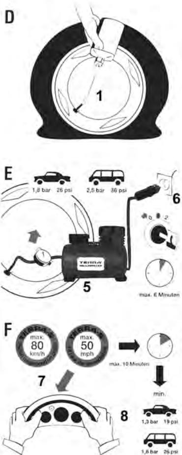
**D** Påfyllingsflasken med påfyllingsslangen holdes nedover og trykkes sammen. Hele flaskeinnholdet trykkes inn i dekket. Påfyllingsslangen ① trekkes av, og ventilinnsatsen ② med ventilutluttredrieren ③ skrues fast inn i dekkventilen.
