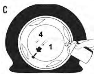
**C** Lukkestuss ④ trekkes av fra påfyllingsslangen ①. Påfyllingsslangen skyves på dekkventilen.
