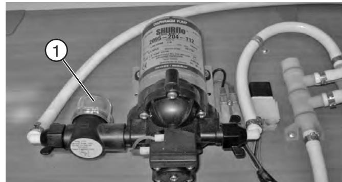
**Tømming av filterhuset på ferskvannspumpen:**
