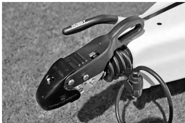
Campingvognen er utstyrt med en sikkerhetskobling med stabilisator som motvirker tilhengerens slingre- og nikkebevegelser. Dette systemet er i samsvar med ISO 11555-1 og er godkjent for bruk opp til en hastighet på maks. 100 km/t. Husk ekstra bruksanvisning og produsentens sikkerhetshenvisninger.
