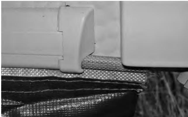
Nederst i på siden er campingvognen utstyrt med noen profilskinner. Understykke skal alltid trekkes inn fra midten av kjøretøyet og ut.
