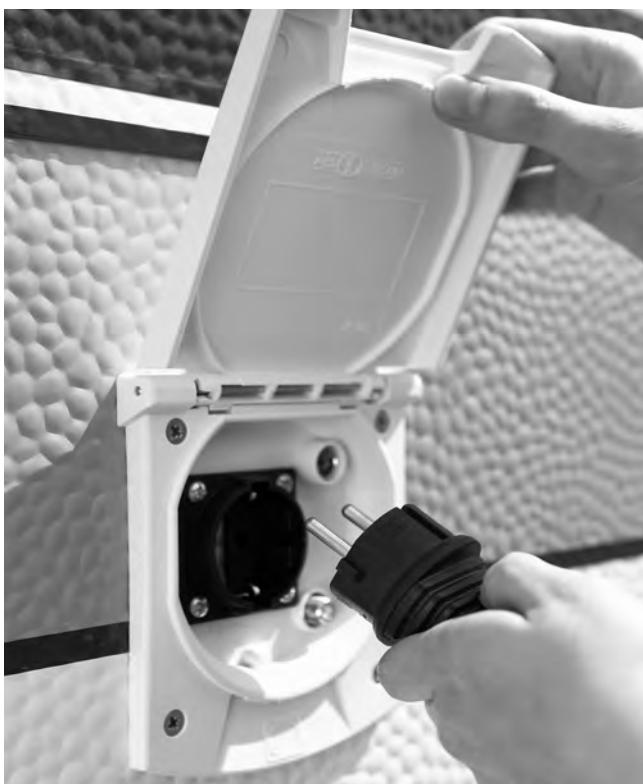
Systemet koples automatisk fra batteridrift til nettdrift så snart systemet blir tilkoplet strømnettet.
