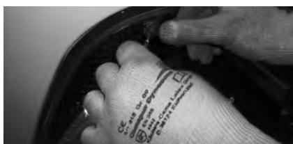
Fjern beskyttelseskappen forsiktig med en skru trekker.
