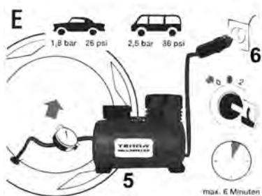
**E** Luftpåfyllingsslange (5) skrues på dekkventilen. Pluggen (6) settes inn i stikkontakten til sigarettenneren. Dekket pumpes opp (7). Den elektriske luftpumpen må ikke brukes lengre enn 8 minutter. Fare for overoppheeting! Hvis lufttrykket ikke kan oppnås, kjøres kjøretøyet ca. 10 meter frem eller tilbake, slik at tetningsmiddelet kan fordeles i dekket. Gjenta pumpeforløpet. Fortsett kjøringen umiddelbart slik at tetningsmiddelet kan fordeles i dekket.
