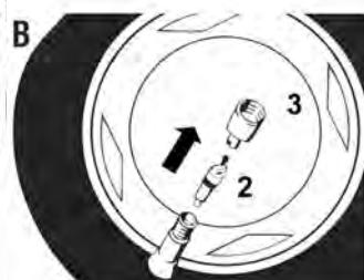
**B** Ventilklassen skrus av dekkventilen. Ventilinnsatsen ② med ventiluttdreier ③ skrus ut. Ventilinnsatsen ② må ikke legges i sand eller skitt.
